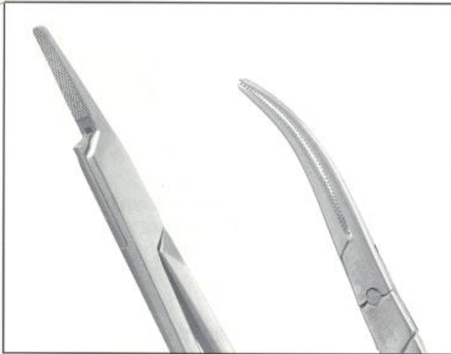
Interner korrodierender Spannungsriß Internal corroding tension crack Incrinatura da tensioni interne corrosa Corrosión en grietas internas por tensión
