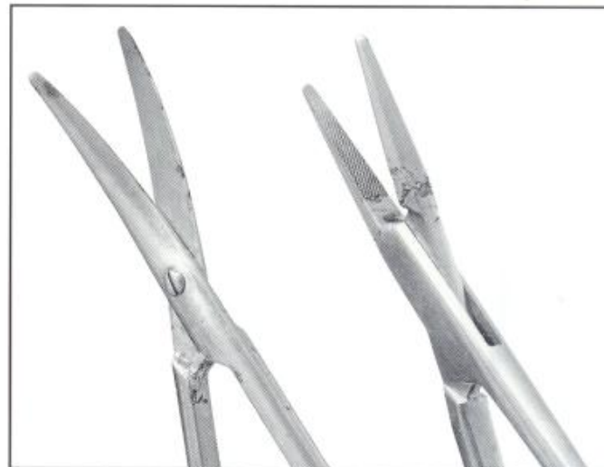
Perforierende Korrosion verursacht durch Chloride Perforating corrosion due to chloride Corrosione perforante causata da cloruri Corrosión perforante causada por cloruro
